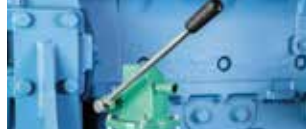
Bomba manual de drenaje de aceite lubricante
