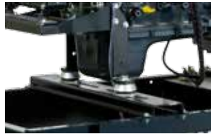
Soportes antivibraciones para aplicaciones intensivas
